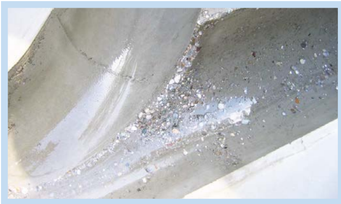
Widerstandsfähigkeit Hochdruckspülung nach 50 Rohrlängen.
