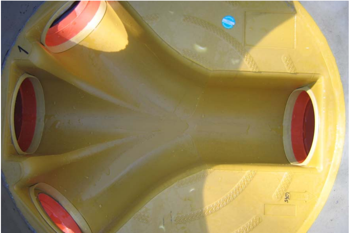
Abbildung 45: PP-Schacht DN 250 nach 50 Rohrlängen
