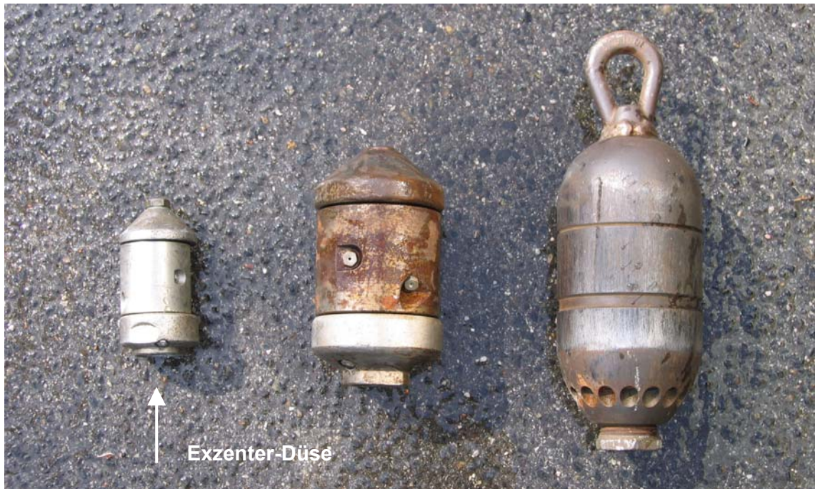
Abbildung 29: Spülköpfe für den Praxisversuch
