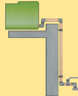
Der Regensammler fasst das Regenwasser im Abflussrohr und leitet es (gefiltert oder ungefiltert) zum Regen-Dachtank. Sobald der Regen-Dachtank voll ist, staut sich das Wasser im Regensammler und läuft über das Regenfallrohr wieder ab. Der Regen-Dachtank überläuft nie!
