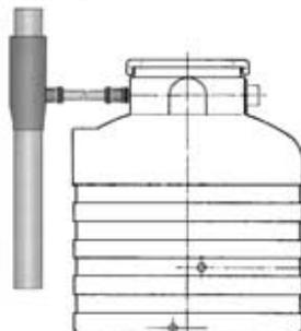
**Dom-Rundtank aus PE-grün**, oberirdischer Wasserspeicher.
